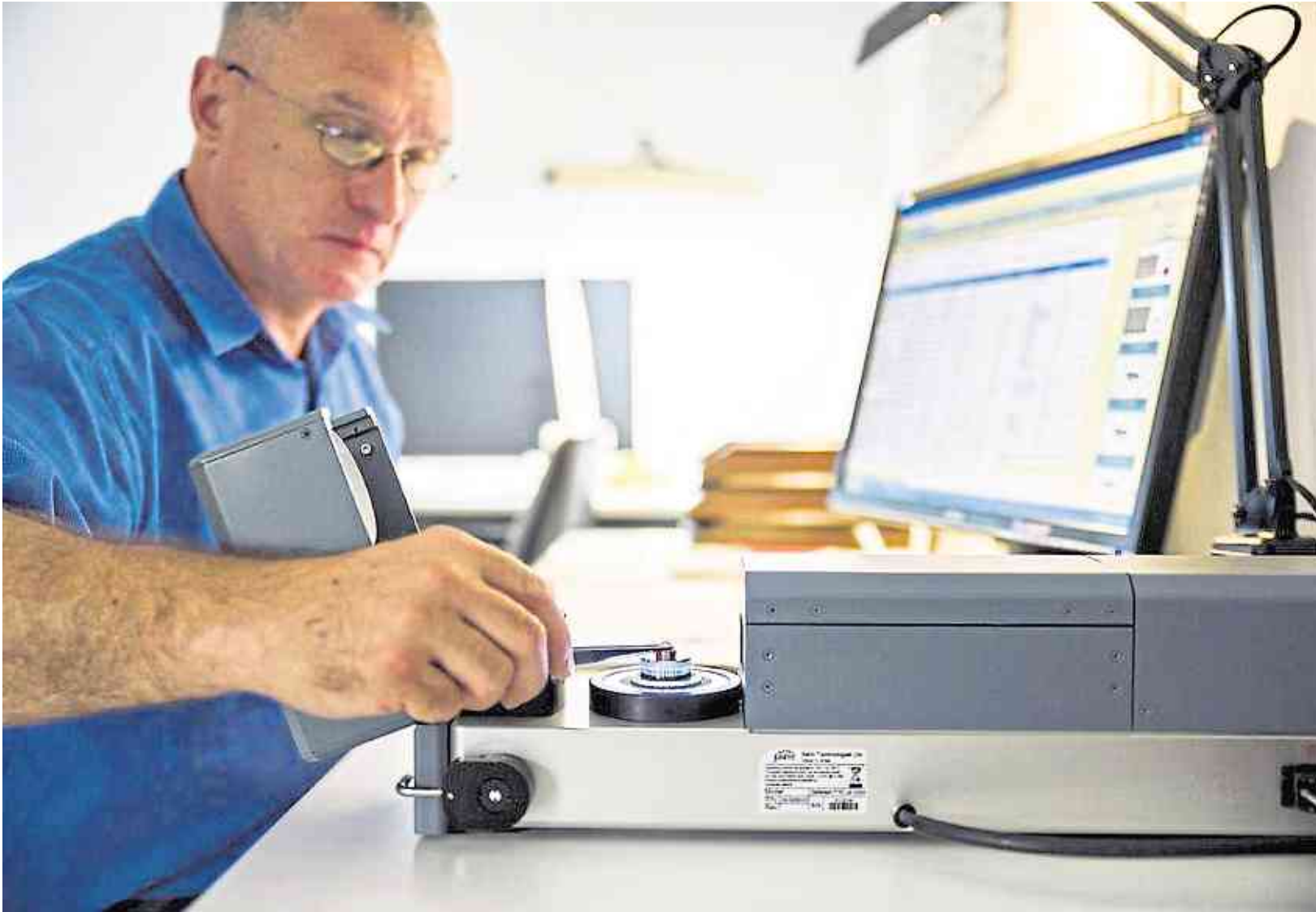
Mit einem Laserstrahl vermisst Jens Gödecke die Oberfläche eines Diamanten, der sich auf einer Drehscheibe befindet. Dabei wird jede Facette exakt vermessen und deren Symmetrie und Proportionen bestimmt. Der Schliff (Cut) ist eines der vier großen C, die den Wert eines Diamanten bestimmen.
